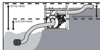
La salida de la bomba se verá afectada por el tipo, la longitud y el tamaño de las mangueras de succión y descarga.
